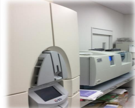
VITEK-2：細菌の種類を調べる機械
