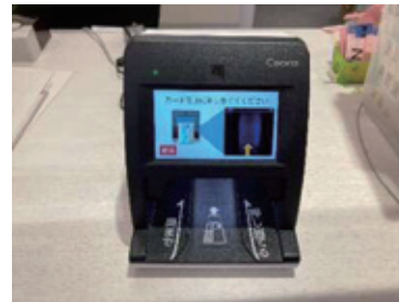
南奈良総合医療センターに設置されている顔認証付きカードリーダー
